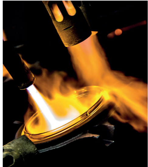
Abb. 40: Feuerpolieren einer gepressten Glasscheibe
